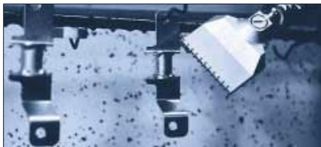
*Dopo il prelievo, i particolari vengono ripuliti dall'acido idrocloridrico prima della zincatura – un ambiente estremamente corrosivo che impone l'utilizzo di ugelli in acciaio inox.*
