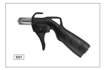
SILVENT 501 genera un cono d'aria potente ed universale ed è particolarmente indicata per il soffiaggio di grandi superfici. Il design ad alette dell'ugello crea un effetto di spinta che aumenta la forza di soffiaggio. Questo ugello, brevettato in tutto il mondo, genera un ridotto livello di rumore nonostante la grande forza di soffiaggio ed un basso consumo d'aria. Brevettata.
